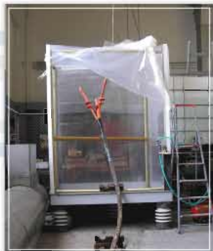
Испытание кабельных муфт 10 кВ в среде соляного тумана
