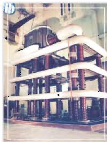
Стенды испытаний изоляции электрооборудования напряжением промышленной частоты 500 кВ (слева), 750 кВ (справа)
