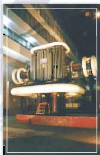
Стенды испытаний изоляции электрооборудования напряжением промышленной частоты 500 кВ (слева), 750 кВ (справа)
